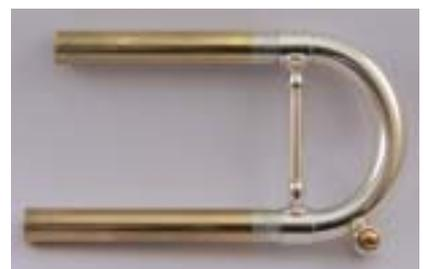
*Gut erkennbar: das obere Rohr wurde schief abgeschnitten.*
