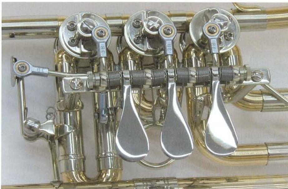
Die neue Maschine läuft leicht und das Trennungverhalten bei schnellen Passagen ist sehr gut.
